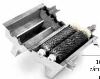
Nože manuálního tenderizéru.
